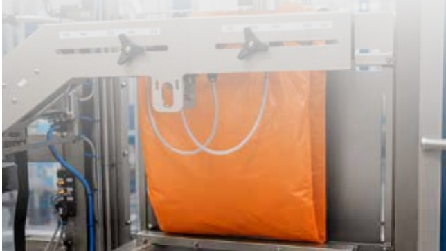
Embolsado con bolsa preformada
